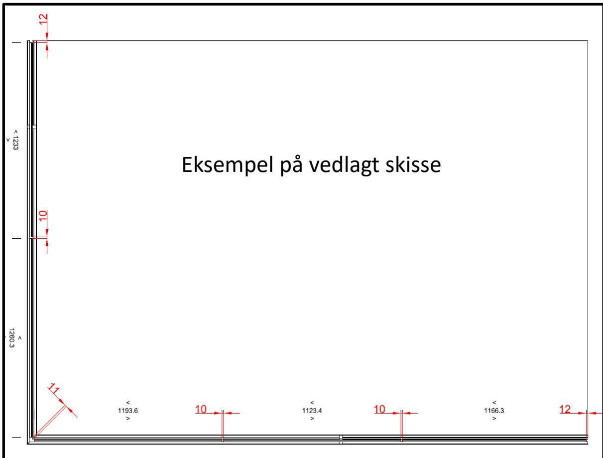
**3.3 Ved veggforankring.** Bruk glasset som mal før du setter glasset fast til å se hvor veggfeste skal monteres.
