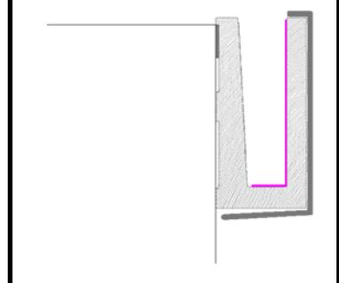
3.2 Det medfølger snittegning til ditt rekktverk som viser glassbredder slik at du ser hvor de forskjellige glassene skal plasseres. Det er beregnet avstand på 12mm fra glass til ende av skinne. Pass på att glass er i lodd. Avstand mellom glass er 10mm. Eksempel;
